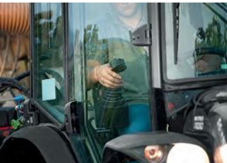
Регулятор постоянной подачи масла на гидравлический разъем позволяет контролировать скорость вращения гидравлических двигателей и одновременно управлять усилием перемещения оборудования.
