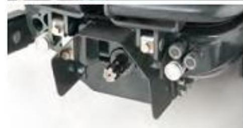
Передний ВОМ\* (1000 об/мин) с гидравлическим приводом и плавным в ключением, с предохранительной кнопкой, не требующий технического ухода.
