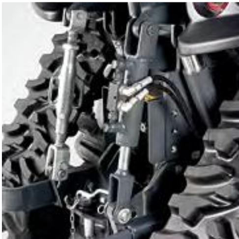
Вертикальная тяговая шланга с гидравлическим управлением при помощи джойстика\* для возможности регулирования с водительского места.
