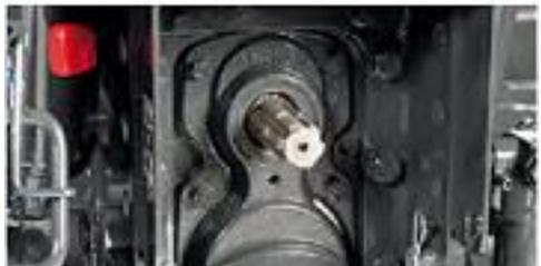
ВОМ с двумя скоростями вращения: 540 об/мин, 540 E (750 об/мин), синхронизируемые со скоростью передачи. Один ВОМ типа ASAE 1 3/8 для обеих скоростей.
