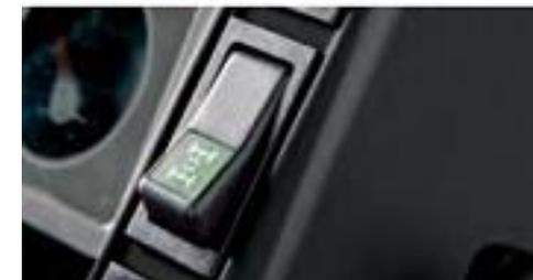
Блокировка дифференциала заднего моста исключает заносы и оптимизирует тяговую силу. Отключение переднего привода полезно при передвижении по дорогам.
