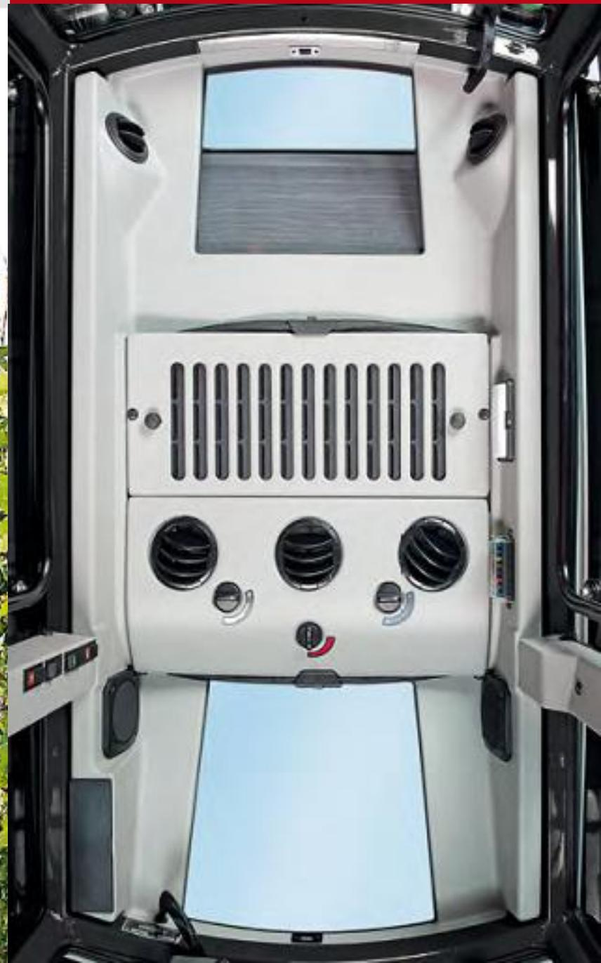
Принудительная вентиляция системы климат-контроля создает эффект внутренней герметизации. Воздух на входе очищается специальным фильтром, по запросу, также фильтром с активированным углем\*.
